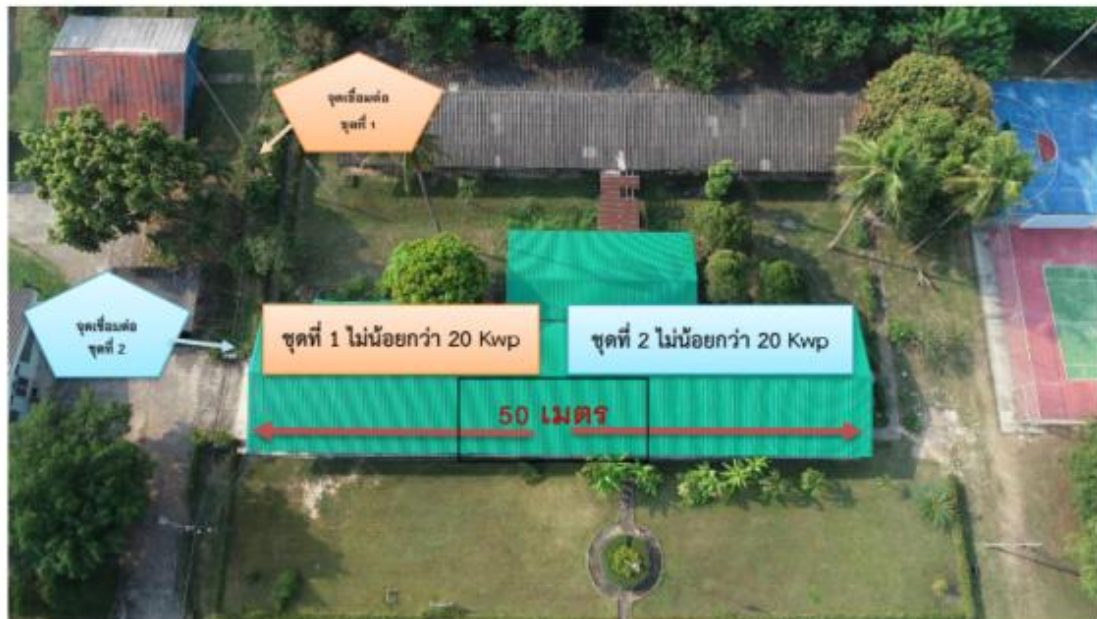
รูปจุดที่ติดตั้ง Solar Rooftop อาคารสำนักงาน
